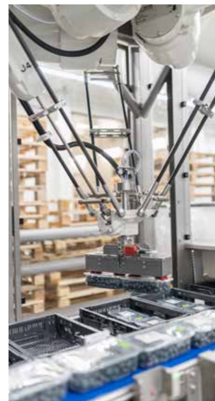
De caseloaders hebben een capaciteit van 75 verpakkingen per minuut
