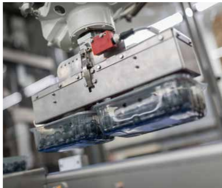
De caseloaders worden bij FruitMasters gebruikt voor het oppakken van zowel kleine als grote schalen
