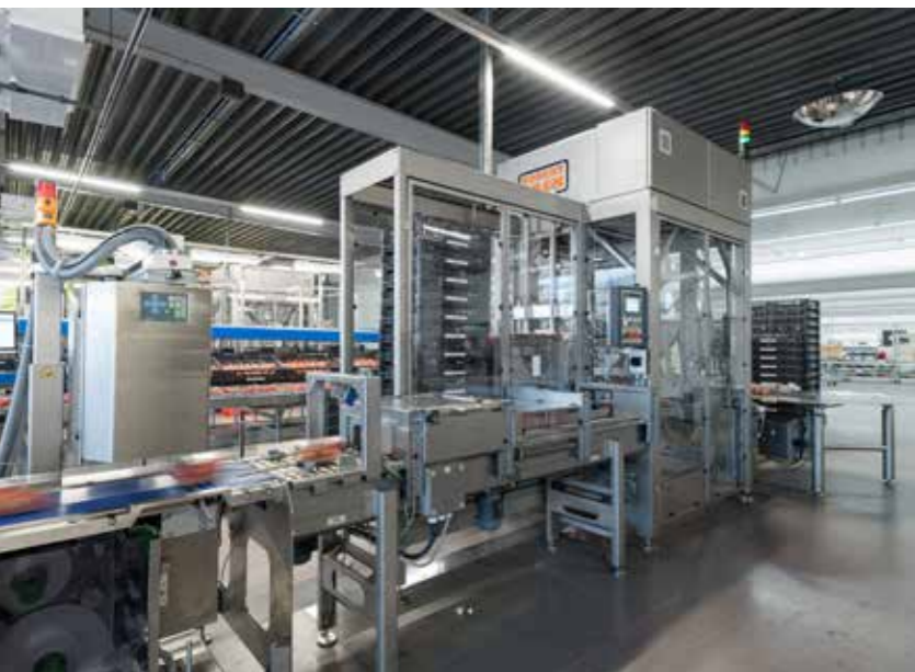
De caseloaders worden bij FruitMasters gebruikt voor het oppakken van zowel kleine als grote schalen
