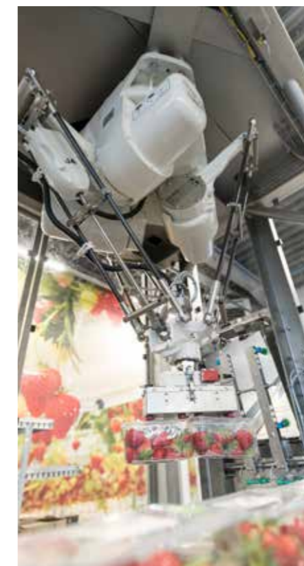
De caseloaders hebben een capaciteit van 75 verpakkingen per minuut
